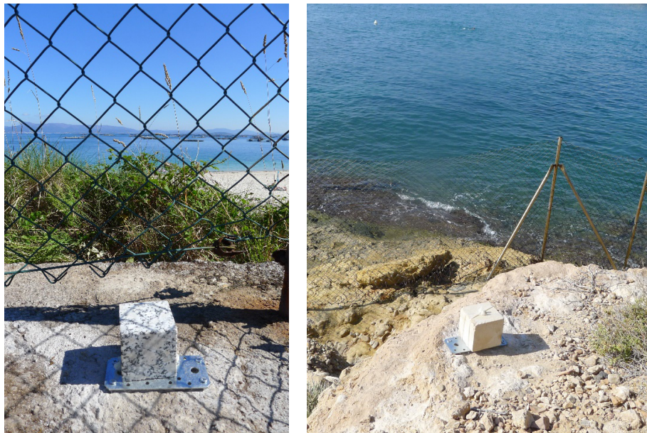
Figura 2. A. Probeta realizada en granito de las mismas características que el empleado en los restos del yacimiento arqueológico de Adro Vello. B, probeta orientación Sur en La Illeta dels Banyets (España).
